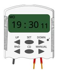
Eine der beiden Adern der Steckdose wird durch das Relais unterbrochen sein. Die beiden Kabel, daran befestigt sind, bilden den Plus- und Minuspol des entstehenden Zeitschalters. Das Kabel, das mit der anderen Ader verbunden ist, kannst du ignorieren.
