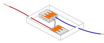
Stoße zwei Löcher in die Seiten einer leeren Streichholzschachtel. Befestige die Klemmen mit Flüssigkleber am Boden der Schachtel und warte, bis alles trocken ist. In der Zeit kannst du Streichhölzer mit einer Schere köpfen. Zwei bis drei kleine Schachteln dürften genug sein.
