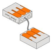
Nimm ein 4,5cm langes Stück Toasterdraht und schiebe es bis zum Ende in die Klemmen. Abhängig vom elektrischen Widerstand des Drahts und den Eigenschaften der Batterien könnte es nötig sein, mit der Länge zu experimentieren.
