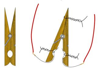
Die Wäscheklammer muss eine starke Feder und einen möglichst großen Öffnungswinkel haben. Binde ihre Griffenden mit einem Draht zusammen. Dann befestige zwei Metallstreifen wie die oben beschriebenen ebenfalls mit Draht am anderen Ende. Wichtig ist, dass die Metallstreifen sich berühren, wenn die Klammer sich schließt und *nicht* Kontakt zur Feder haben. Sonst ist der Stromkreis von Anfang an geschlossen.
