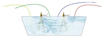
Wichtig ist, dass die Kabel eindeutig zuzuordnen sind, da der Eisblock meistens wenig durchsichtig ist. Falls die Pole im Eifer des Gefechts falsch angeschlossen werden, entsteht eine logische UND-Schaltung statt einer ODER-Schaltung, was den Sinn des Ganzen untergräbt.
